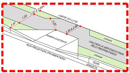
RAMPA DE ACESSIBILIDADE EXISTENTE E CALÇADA DE 2,00m À 4,00m A SER EXECUTADA PELO PROPRIETÁRIO
